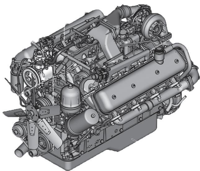
Мы оснащаем нашу машину мощным отечественным двигателем ЯМЗ-238НД5.
