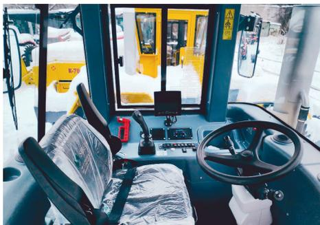
Эргономичное сиденье с 2-точечным ремнем безопасности и регулировками позволит оператору настроить свое рабочее место индивидуально под себя и с комфортом работать в любых условиях. Благоприятный климат внутри кабины создает штатный кондиционер и отопитель.
