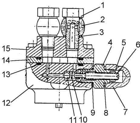
Рис. 28 Редукционный клапан топливного насоса
