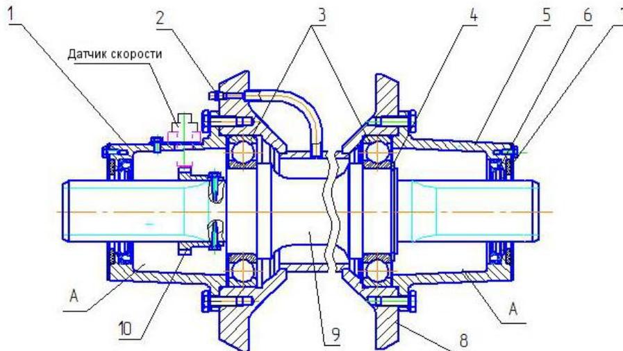
Рис. 41 Опора промежуточная
