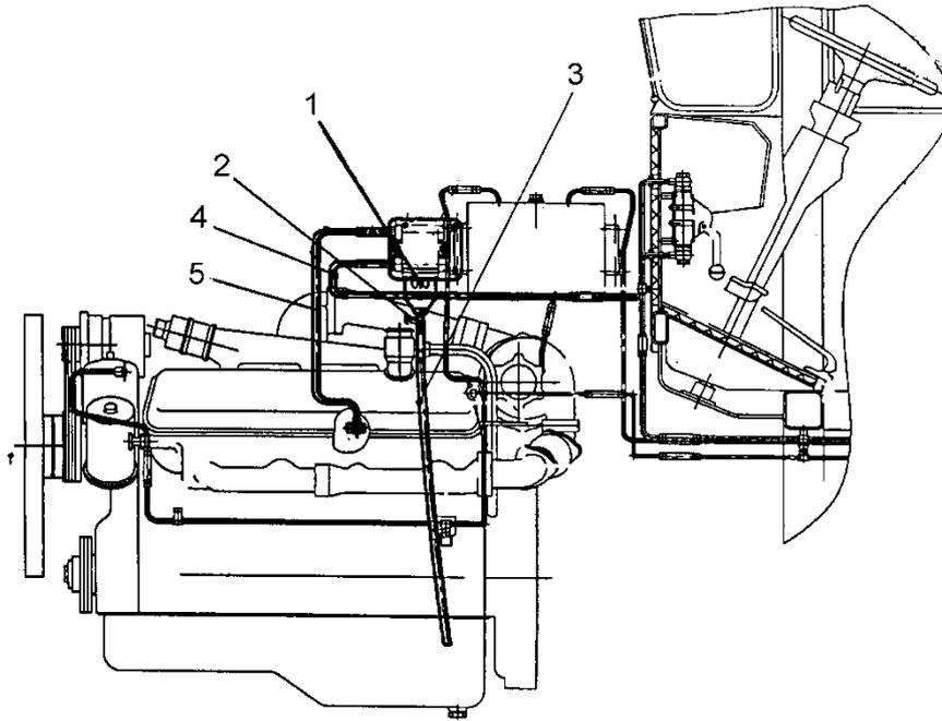
Рис. 23 Подогрев фильтра очистки топлива (для Северного исполнения)
