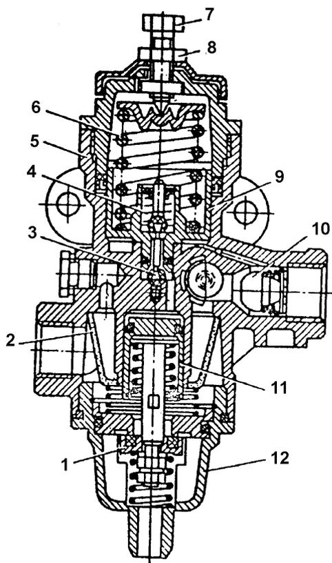
Рис. 72 Регулятор давления
