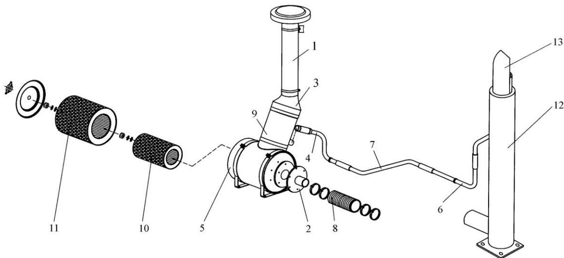
**Рис. 29 Система очистки воздуха и выпуска отработавших газов**
