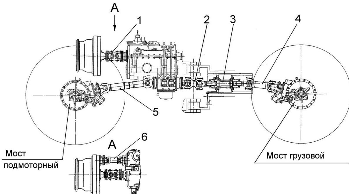
Рис. 40 Передача карданная
