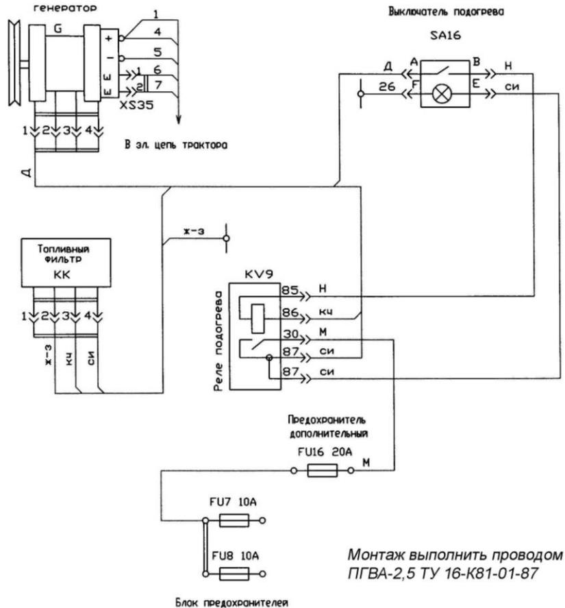
Рис. 62 Топливный фильтр "Separ" двигателя. Схема электрическая соединений
