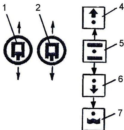
Рис. 13 Схема управления рычагами гидрораспределителя
