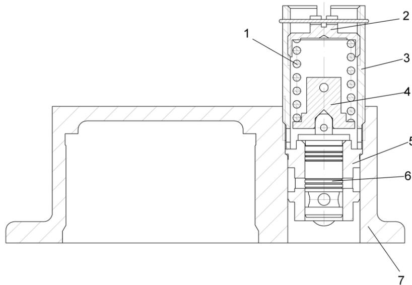
**Рис. 36 Редукционный клапан**
