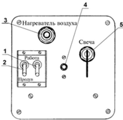
Рис. 25 Щиток управления подогревателем
