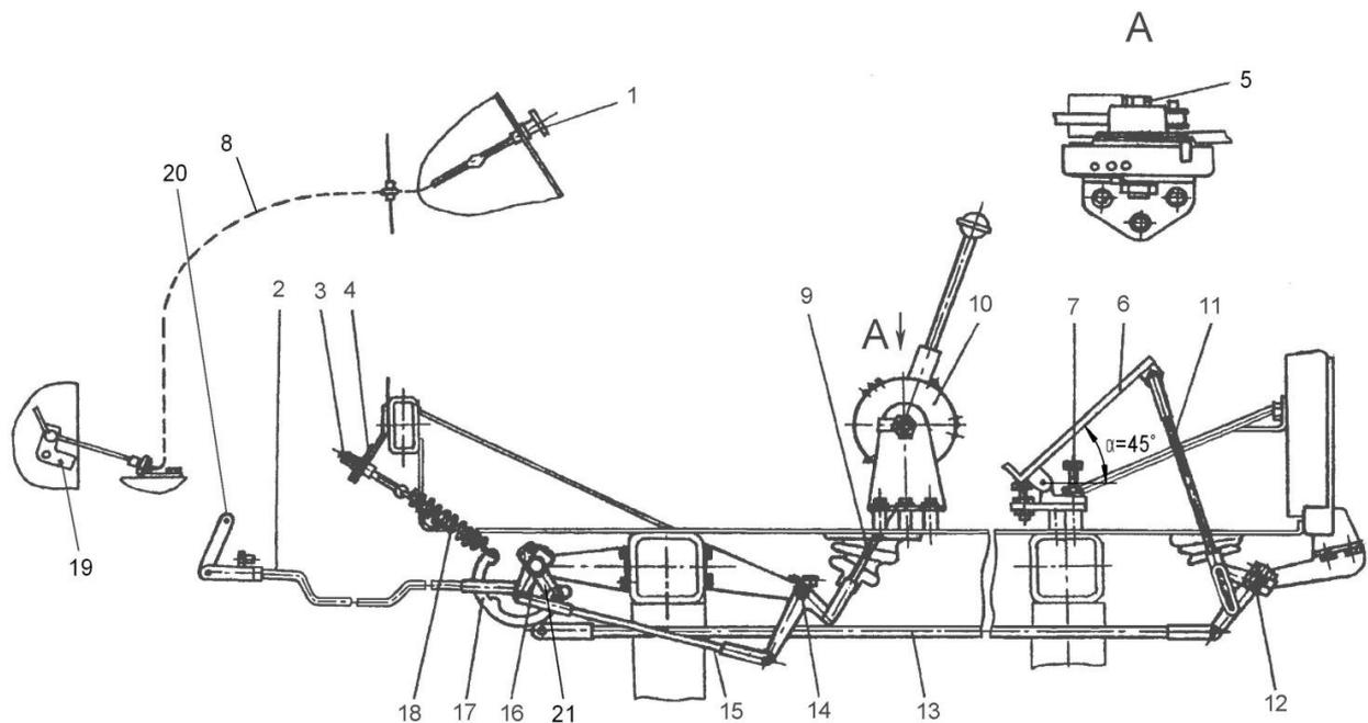
**Рис. 77 Схема привода управления и останова двигателя**
