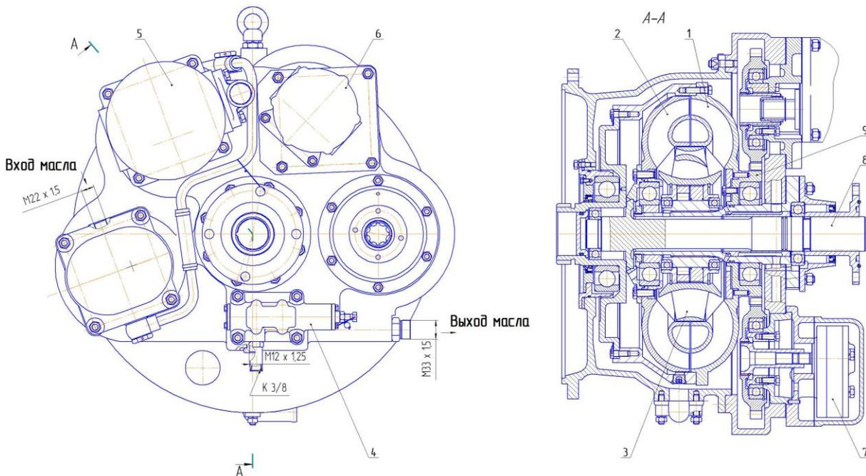
Рис. 30 Гидротрансформатор
